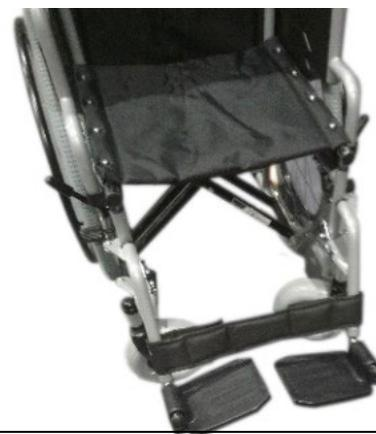
**Montieren Sie die Fußauflage**, indem Sie die daran befestigten Scharnierplatten an den Scharnierstiften am Rahmen des Rollstuhls befestigen. Drücken Sie die Fußauflage zur Mitte des Rollstuhls, bis sie einrastet. Wiederholen Sie diesen Vorgang bei der anderen Fußauflage.
